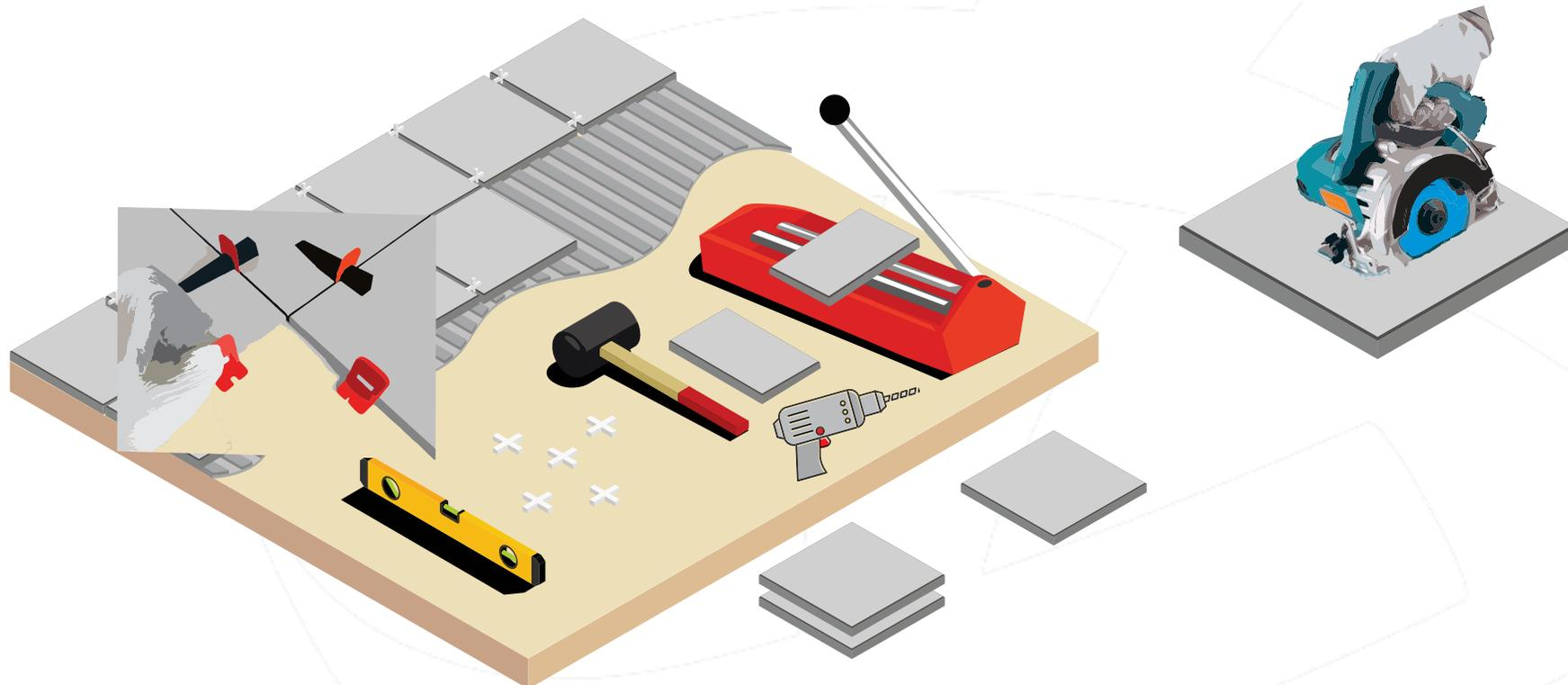
Para cortes retos podem ser utilizados riscadores manuais, que devem estar lubrificados e com a vídea nova ou em bom estado e adequada para uso em porcelanatos e aos formatos que serão utilizados.
